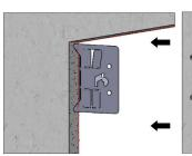
STEP 6- POSITION THE PLATE ON THE INSIDE OF THE PLASTERBOARD WALL AS IN THE PICTURE
