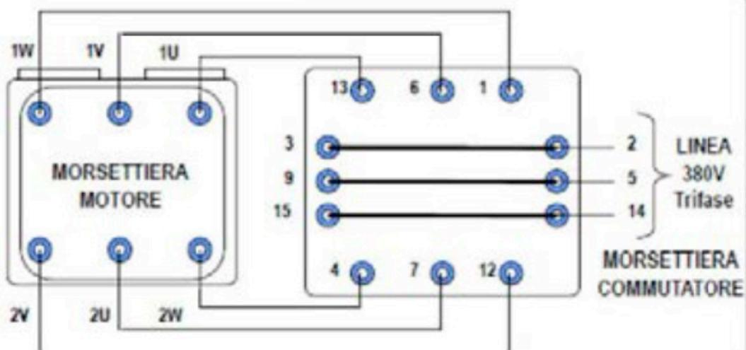
Collegamento a commutatore di polarità Gardair
