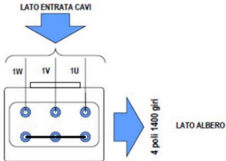
Collegamento diretto alla linea per motori ad una polarità e tensione 380V trifase
