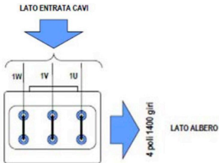
Collegamento diretto alla linea per motori ad una polarità e tensione 220V trifase
